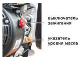
пробка масляного/маслозаливного отверстия индикатор уровня масла в вибровозбудителе
