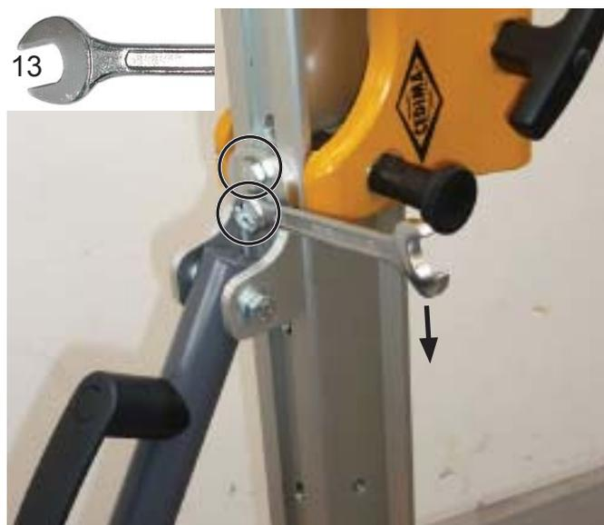
Затягивание винта опоры на колонне Рис. 4.14
