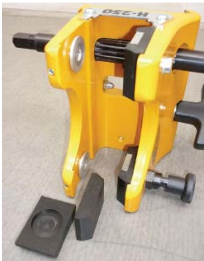
Салазки сняты с колонны, регулируемые сухари сняты с салазок
