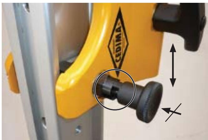
Стопор на салазках H•250 снят (расфиксирован)
