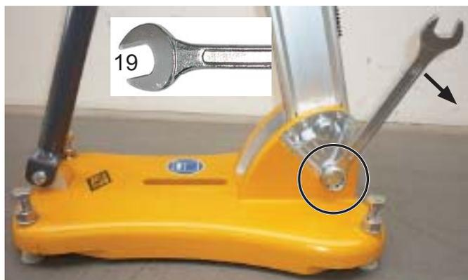
Зажим нижнего винта колонны на подножке Рис. 4.13
