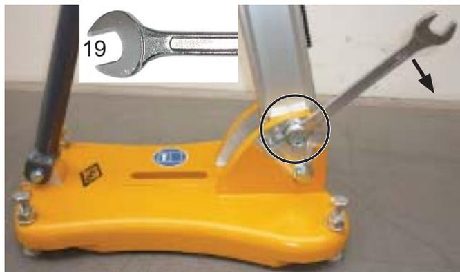
Зажим верхнего винта колонны на подножке Рис. 4.12
