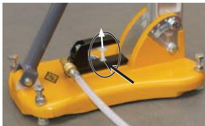
Снятие вакуумного крепления Рис. 4.35
