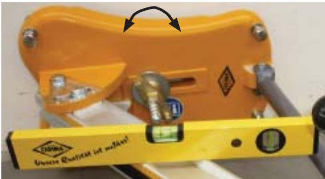
Выравнивание системы с (внешним) водяным уровнем на дюбельном винте (поворачивание) Рис. 4.22
