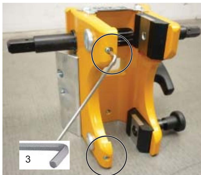
Фиксирующие винты регулировочных винтов сухарей
