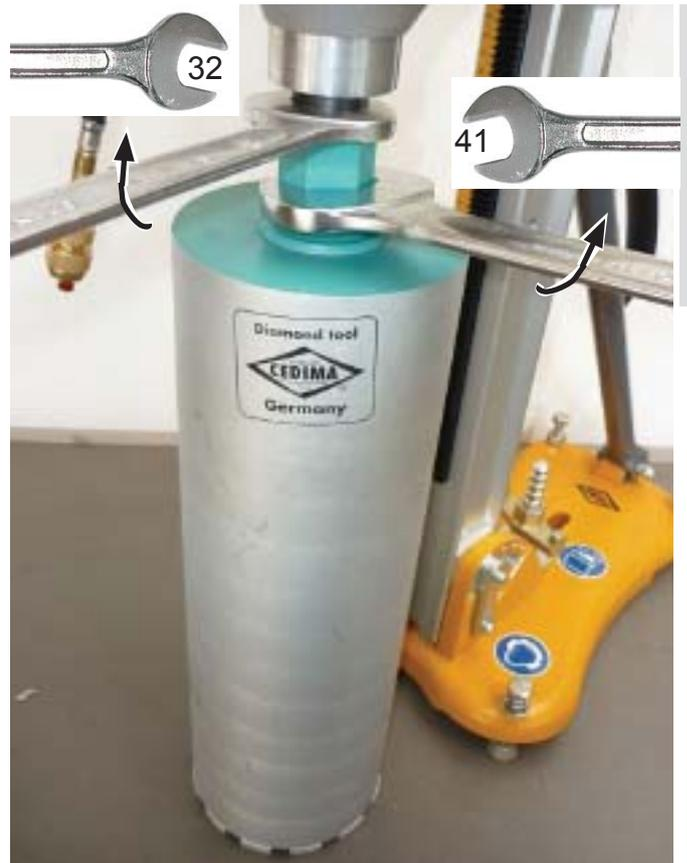
Затягивание алмазной коронки
