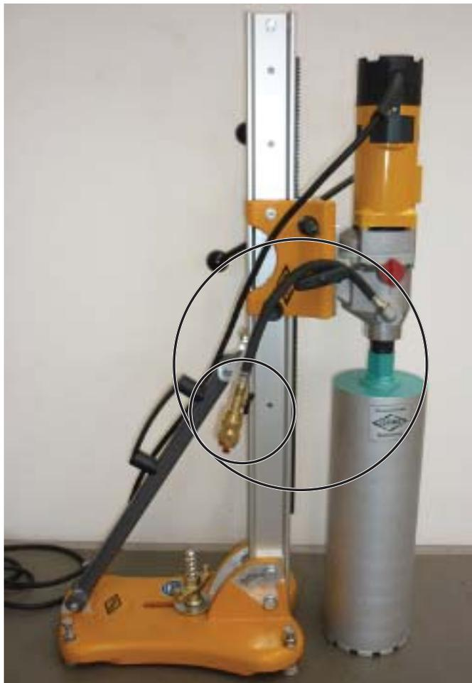
Водяной разъем (с регулир./запорным краном) от электромотора С-BMS•200/3 на H•250 с коронкой Рис. 4.68
