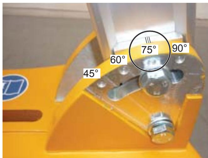
Наклон колонны на нужный угол (напр. 75°)
