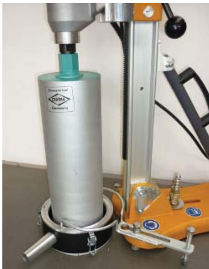
Водосборное кольцо с держателем смонтирована на подножку Н•250 и выровнено на коронку Ø 151 мм Рис. 4.66
