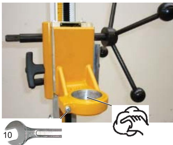
Ослабьте зажимной винт на пласт. крепл. тип В
