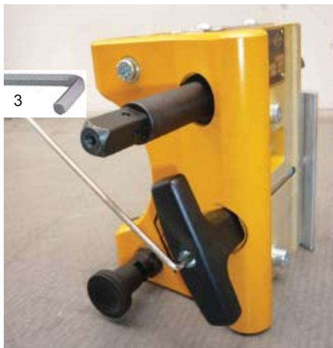
Вывинчивание установочного винта
