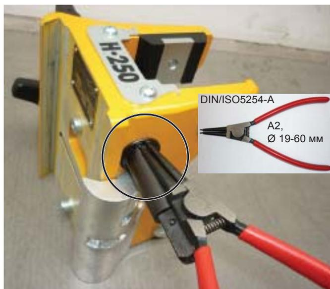
Снятие упорного кольца с вала шестерни
