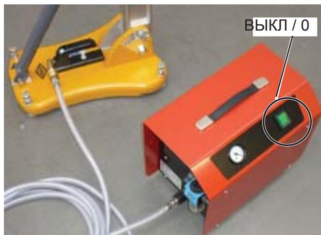
Выключение вакуумного насоса VPU•206 Рис. 4.34
