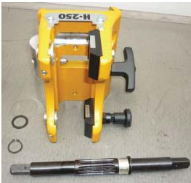
Вал шестерни с втулкой сняты
