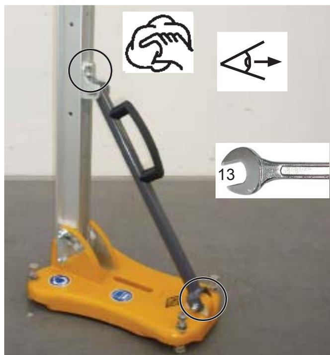
Соединительные элементы смонтированной опоры Рис. 6.30
