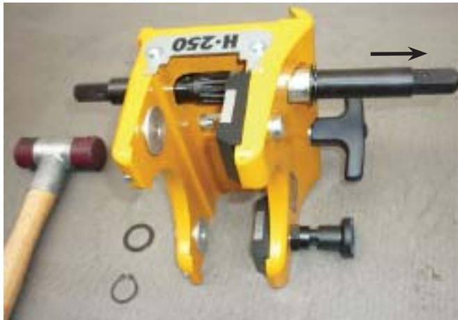
Выбивание вала шестерни с втулкой подшипника
