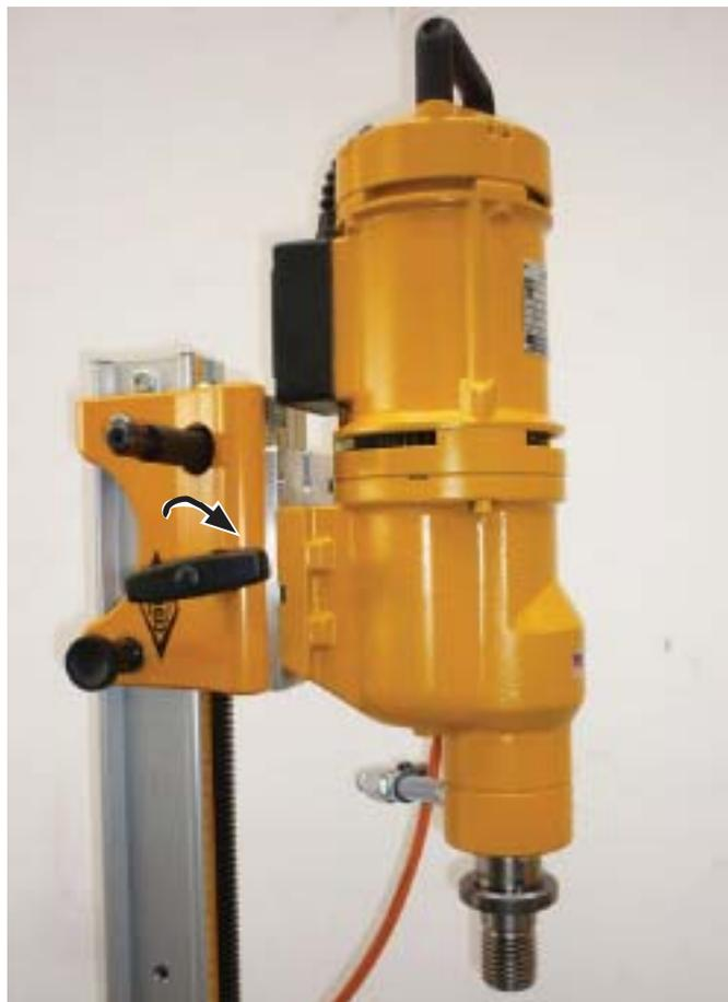
Двигатель с монтажным фланцем, здесь DK•32 EL(C)
