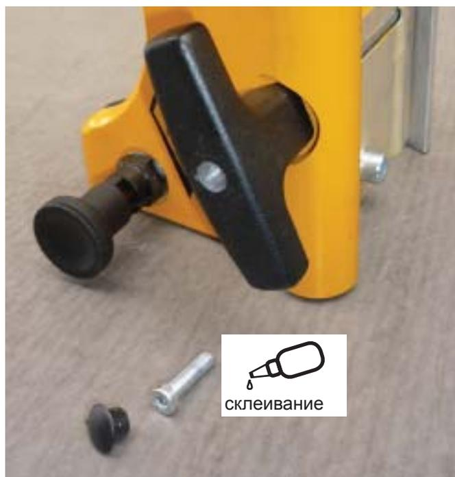
Установочный винт отвинчен
