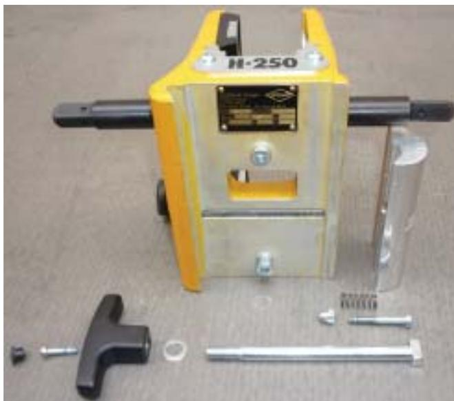
Управление и прижимная колодка сняты
