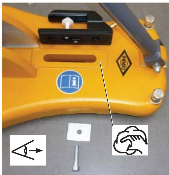
Монтаж блока вакуумного подключения из доп. вакуумного комплекта Рис. 4.27
