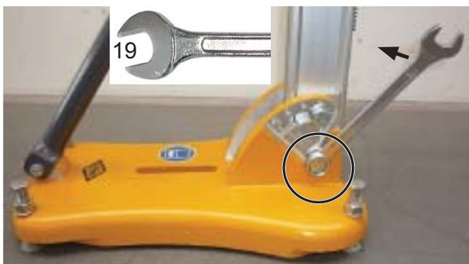
Ослабление опорного винта на колонне на подножке
