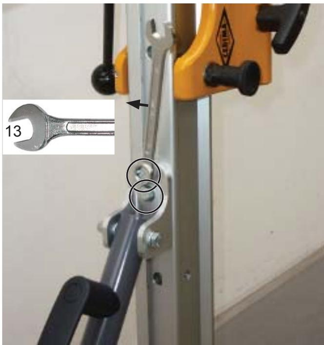
Отвинчивание винтов опоры на колонне
