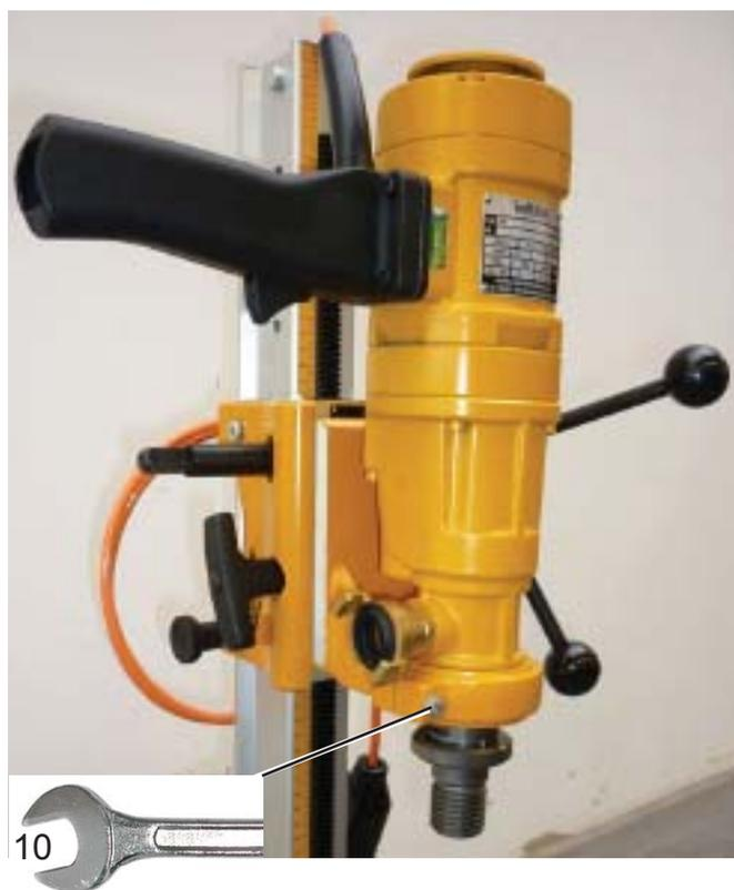
Двигатель с шейкой крепления, тут DK•17 EL заказ-№ 47 99, вставлен в пластину крепл. тип В и зафиксирован зажимным винтом
