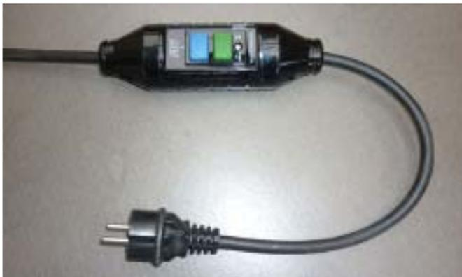
PRCD в кабеле электромотора
