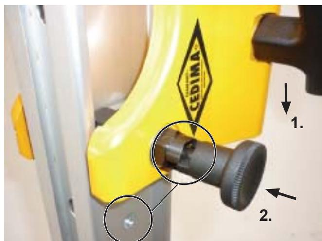
Стопор на салазках H•250 в положении установки, улавливания
