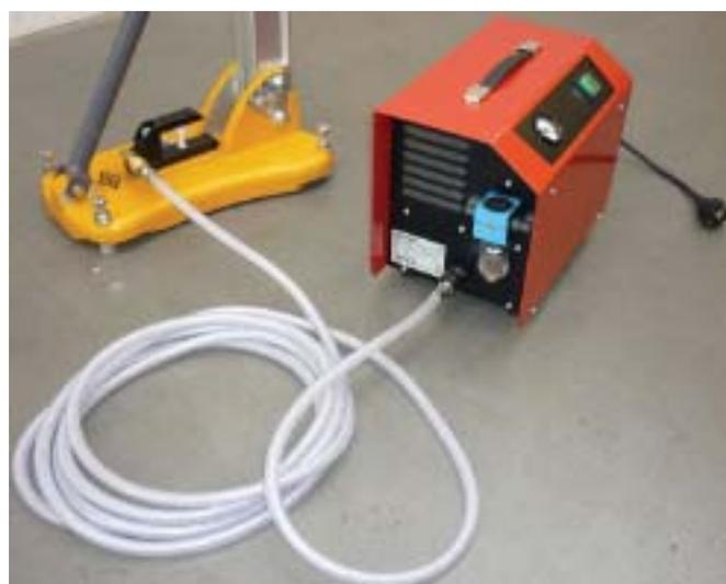
Смонтированный вакуумный комплект подключен к доп. вакуумному насосу VPU•206 Рис. 4.31
