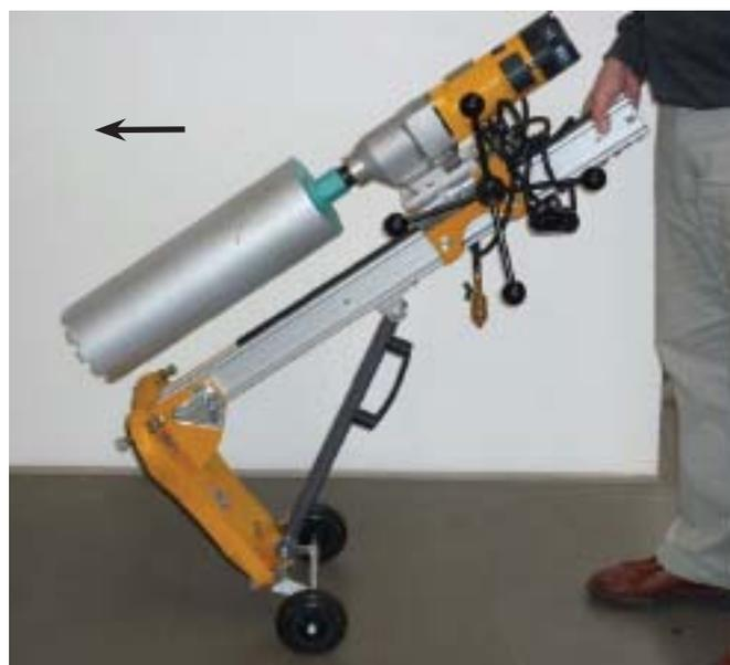
Передвижения сверильной системы (станины с двигателем и коронкой) с доп. компл. колес
