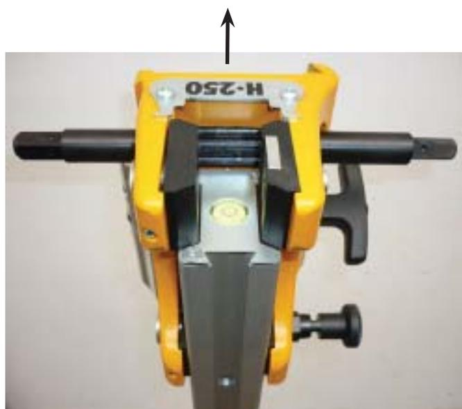
Снимите салазки с сверлильной колонны
